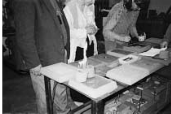
6. De designade sandplattorna sätts i brand för att förbereda dem för senare gjutning.
